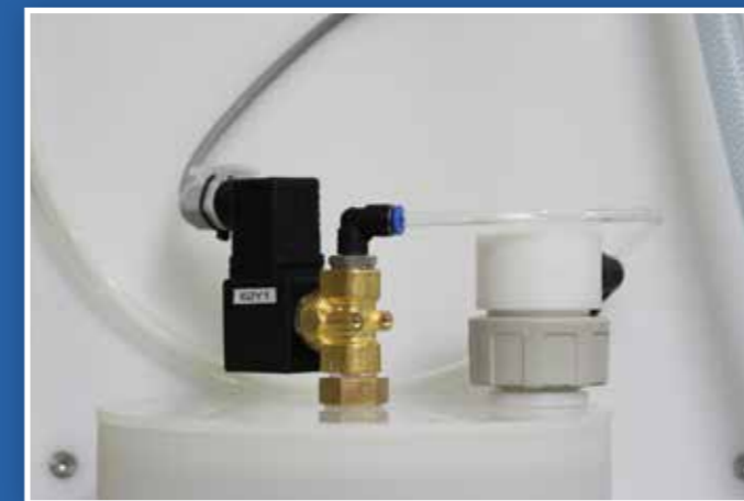
Option: Wasserzugabe als dritte Komponente Option: water supply as third component
