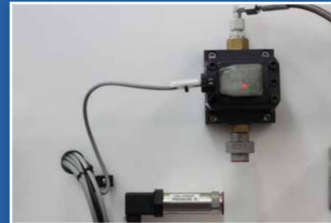
Durchflussmesszelle für den Härter mit Filter Gear flow meter for catalyst with filter
